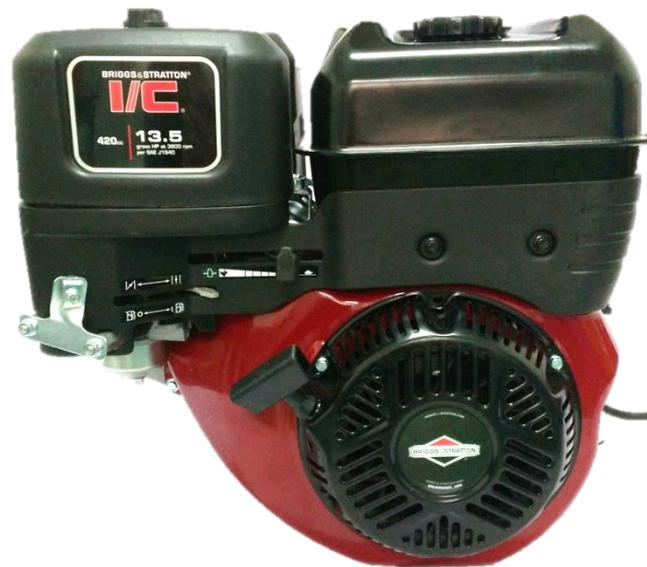
制造商：美国Briggs & Stratton公司生产的新一代单缸四冲程风冷型汽油机，排量420cc，功率13.5马力，配备手电一体启动装置，磁控管点火系统，带内置油泵的压力式化油器，大容量双层过滤器，及带压力开关的全压润滑系统。
