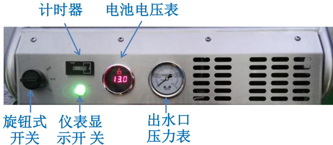
不锈钢耐腐蚀操作面板包括：计时器、旋钮式开关、电池电压表、仪表显示开关及出水口压力表。全防水仪表。
